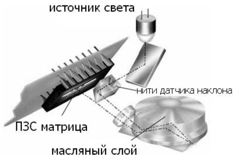
Рис. 6 Принцип работы двухосного датчика наклона (компенсатора)
